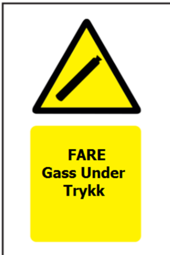
Figur 1.3 – Utstyr som inneholder akkumulatører, inneholder gass (nitrogen) under trykk. Ved brann kan det oppstå sprengningsfare.
